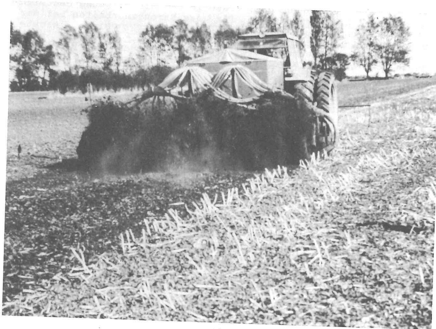
Bild 2: Samenablage unter dem Bodenwurf einer Fräse durch eine über die Frässhöle schleifende Breitsächiene
