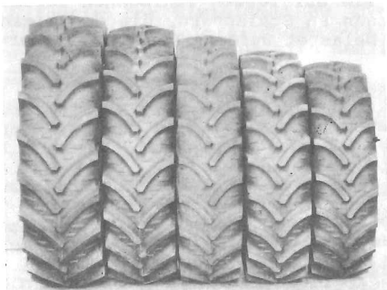
Bild 4: Zur Untersuchung eingesetzte Reifen. Von rechts: 16.9 R 30, 16.9 R 34, 16.9 R 38, 18.4 R 38, 20.8 R 38
